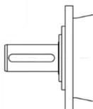
Цилиндрический вал с пазом под шпонку (Z)
