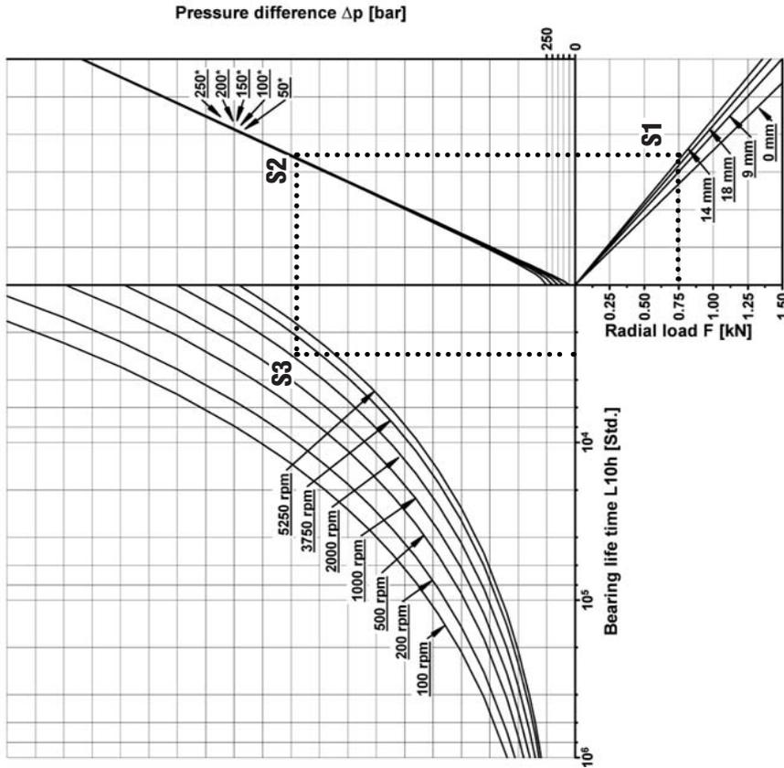
**Given:** Radial load  $F_r = 0,75 \text{ kN}$
