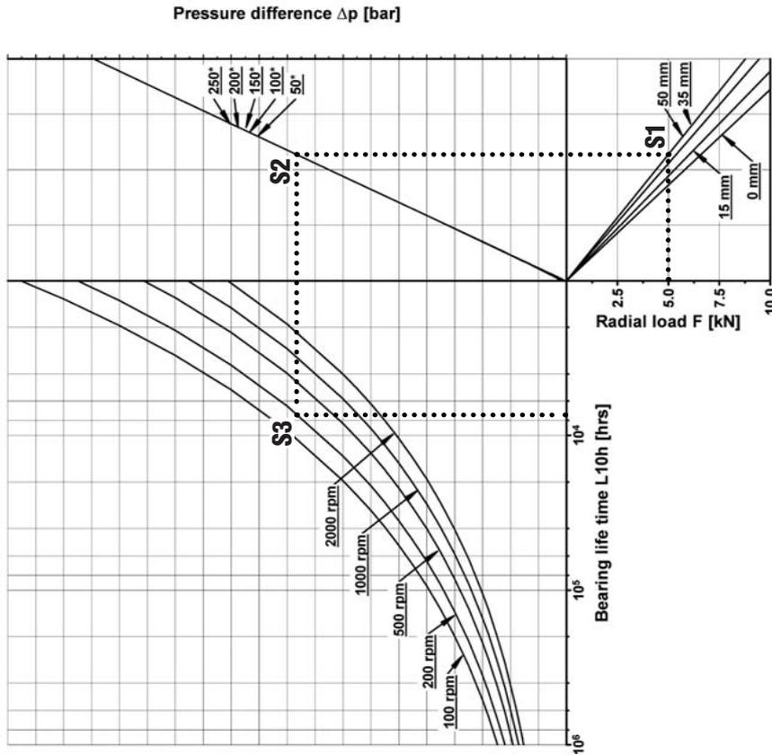
**Given:** Radial load  $F_r = 5 \text{ kN}$
