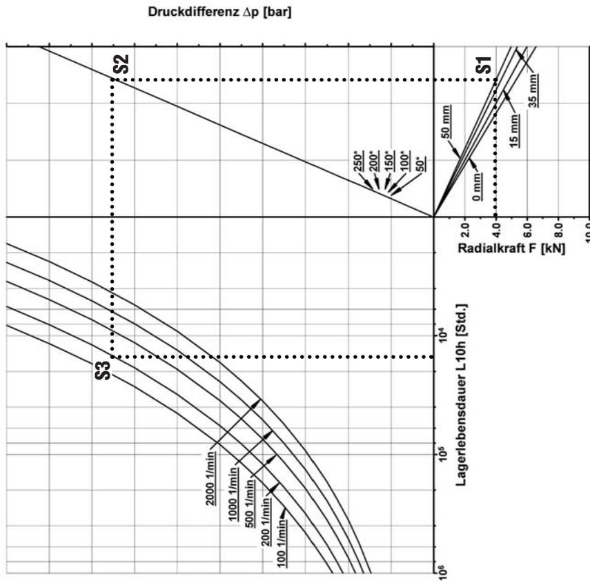
**Given:** Radial load  $F_r = 4.0 \text{ kN}$
